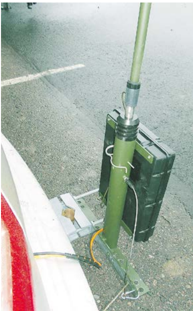
Ajoneuvoissa käytettiin LV681 MPK-kalustoa, johon kuuluu lanka-antenni, tässä maston kiinnitys auton taakse.
