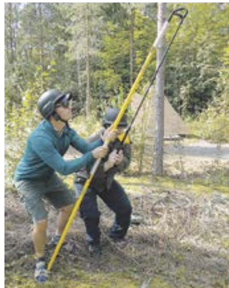
Antenninirtsalla saadaan vetonaru helposti puun latvan tasalle, ja vieläpä tarkasti sivusuunnassa.
