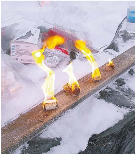
Jaossa olleet sytytyspalat paloikatestissä, tyynellä säällä Flamgo paloi 8 minuuttia.
