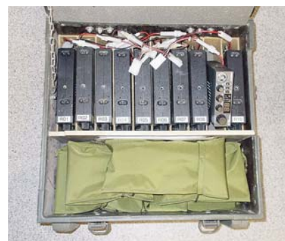
Isomman porukan viiden watin ajoneuvokonesalkku täyttää 10 kilometrin kantamatarpeet 10 asemalle (tai varakoneiden kanssa 5 asemalle).
