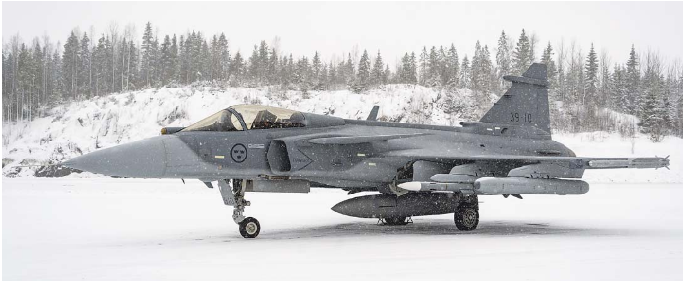
Saab 39 E Gripen teki ensimmäisen lentonsa ulkomaille saapuessaan Pirkkalaan 29. tammikuuta. Talvisessa kelissä laskeutuneen hävittäjän ulkoisena kuormana oli lisäpolttoaine-säiliö sekä siivenkärjissä Dielh BGT:n IRIS-T -ilmataisteluohjukset. Nämä olivat asennettuina koneeseen myös mediapäivänä.
