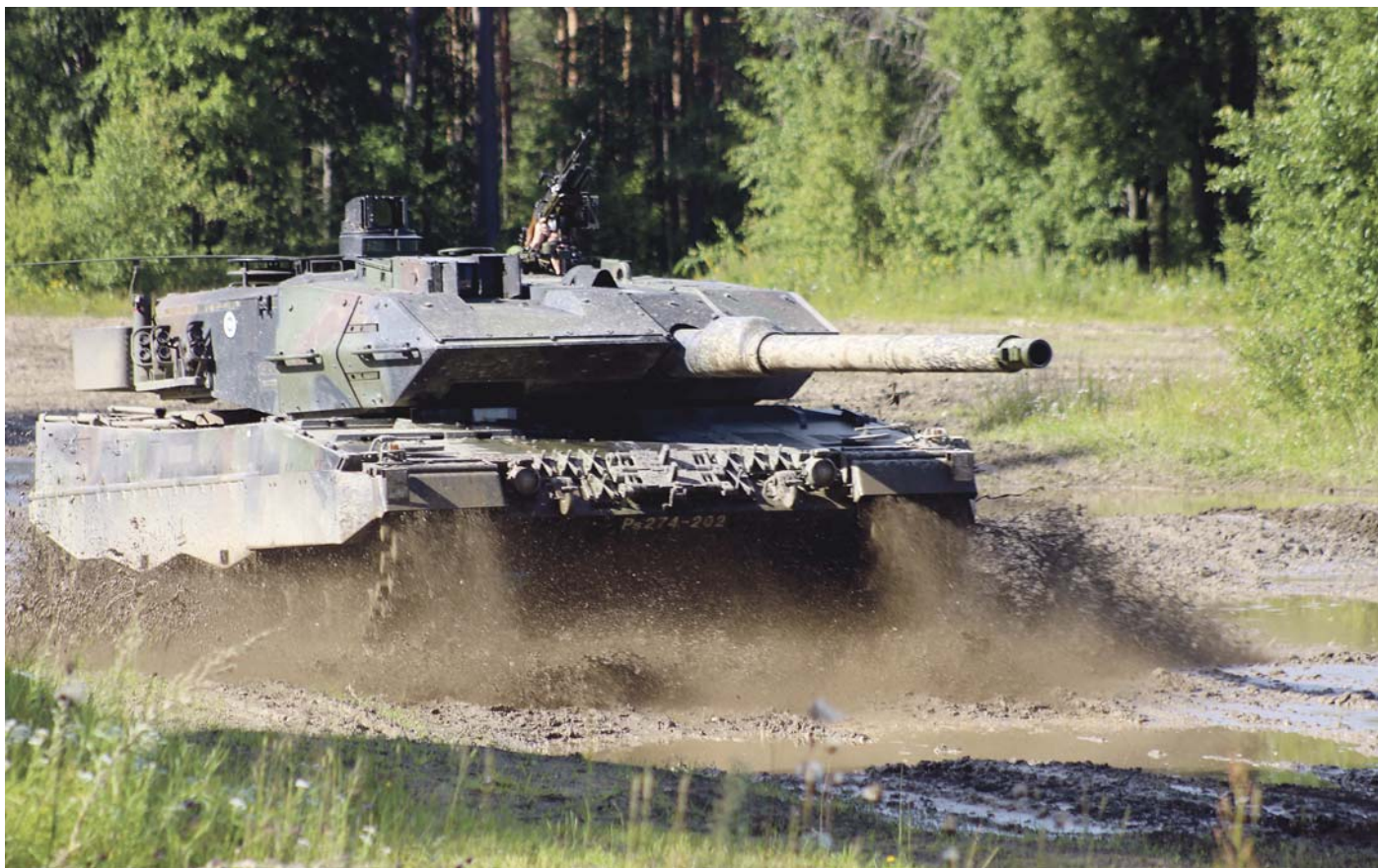
Hollannista hankittujen Leopard 2 A6 -taistelupanssarivaunujen pääase on 120 mm:n vaunukanuuna. Verrattuna Suomessa aiemmin käytössä olevaan A4-vaunuun uudessa A6-mallissa on mm. pitempi tykinputki, mikä tietenkin lisää ammuksen lähtönopeutta ja läpäisevyyttä. Järjestelmä mahdollistaa suorasuuntausampumisen jopa 4000 metriin, mutta käytännön maksimiampumaetäisyys peitteisessä maastossamme on 800–1500 m. 60 tonnin painoisessa vaunussa on neljän hengen miehistö (johtaja, ajaja, ampuja ja lataaja).
