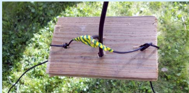
Viestimies-kilpailussa tehtävänä oli muun muassa tilapäisdipolin teko parikaapelista ja mitoitus tietyille taajuuksille.
