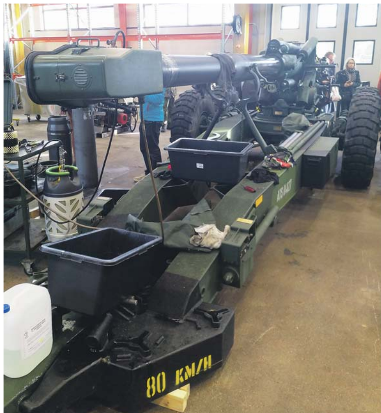
155 K 83-97 kenttätykki, jonka putki on kuparinpoistokäsittelyssä MILFOAM-laitteistolla.
